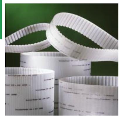
La courroie en polyuréthane à pas métrique SynchroPower® offre un rapport qualité/prix optimal. Elle transmet un maximum de puissance, assure un excellent engrènement des dents et a des tolérances très précises. Cette courroie peut fonctionner à des vitesses linéaires de 75 m/s. Grâce à la réduction de fatigue de flexion, la vie de la courroie est notablement prolongée.
